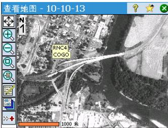
*地图视图*是当前作业中的对象的图形表示。它将在背景中显示*底图*，如果您使用了的话（见屏幕示例）。
