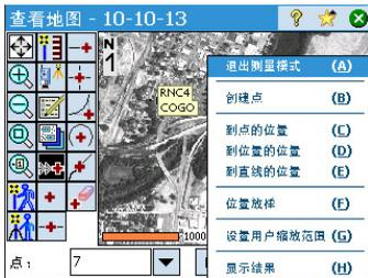
如果选择了光学或 GNSS，主地图也会充当采集仪器的接口。按住主地图并选择**测量模式**以后用测量界面（见针对 GNSS 的屏幕示例）。
