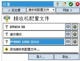
日后您开始测量时，只需选择所需的接收机配置文件 - 和**网络配置文件**（如果您工作在网络中）；在让 Survey Pro 连接到您使用的接收机之前，也看看 \*\*\* '管理网络配置文件' on page 28 \*\*\*。Survey Pro 将根据所选择的接收机配置文件中定义的设置接收机硬件配置。
